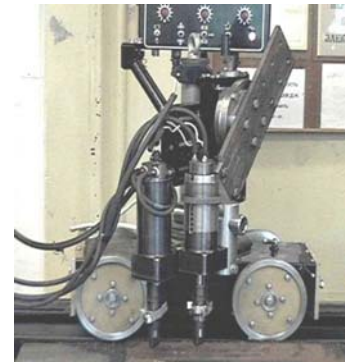
Fig. 30 Mechanized UIT of welds
